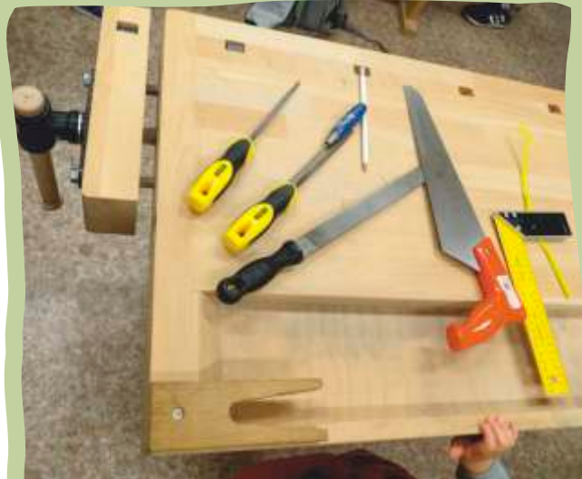
Truhlářská hoblice může být doplněna druhým svěrákem, šuplíky či políčkami na nástroje a materiál.
