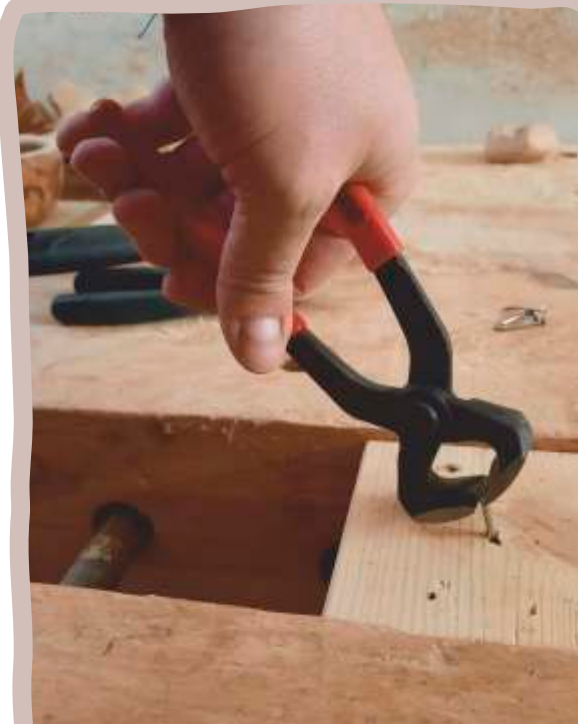
Vytahování zkřivených hřebíků pomocí štípacích kleští.
