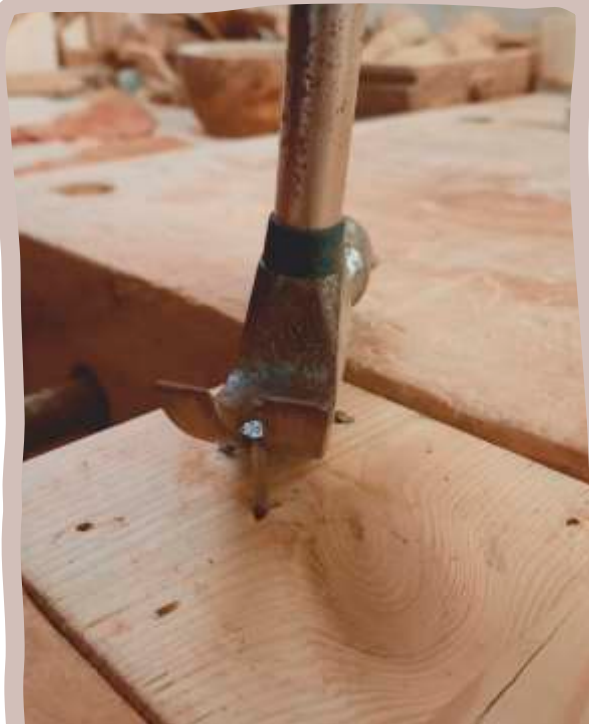
Vytahování zkřivených hřebíků pomocí nosu kladiva.
