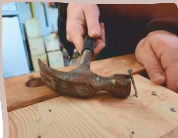
Narovnání křivě zatloučeného hřebíku úderem kladiva z boku.
