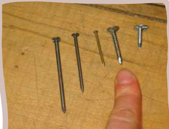
Dětem se dobře zatloukají hřebíky s velkou hlavičkou.
