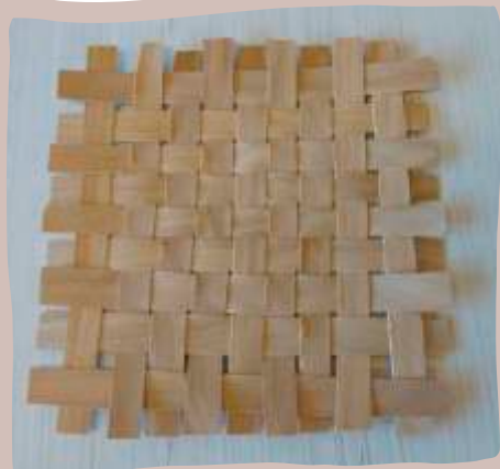
Podložka pod hrnec z dýhy: nácvik střídavého provlékání pod a nad osnovou.
